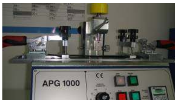
Figura 5. Dispozitivul de testare la abraziune a suprafețelor acoperite cu strat de TPE glisant Figure 5. Abrasion testing device for surfaces covered with sliding TPE layer
