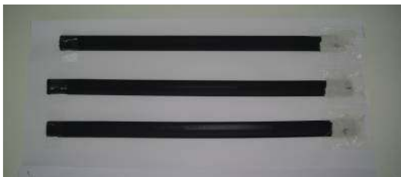
Figura 7. Rezultatele testului de abraziune a stratului coextrudat glisant din TPE Lubmer TM80
