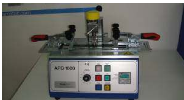
Figura 5. Dispozitivul de testare la abraziune a suprafețelor acoperite cu strat de TPE glisant Figure 5. Abrasion testing device for surfaces covered with sliding TPE layer
